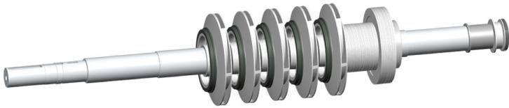
先进的精铸工艺使叶轮和导叶的流道光滑，叶轮单独静平衡，转子部件整体动平衡，降低了振动，延长了机械密封和轴承的使用寿命。
